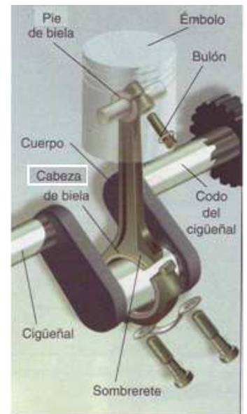
Fig. 7. Esquema del funcionamiento del mecanismo biela-cigüeñal en un motor de combustión.
