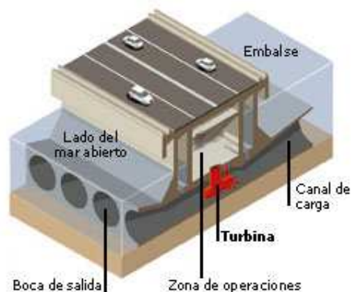
Esquema de funcionamiento de una central mareomotriz
