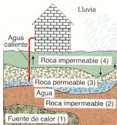
El agua adquirirá la temperatura del sistema geotérmico y se encontrará en estado líquido, en forma de vapor o como mezcla de líquido y vapor según las condiciones de P y T del yacimiento:
