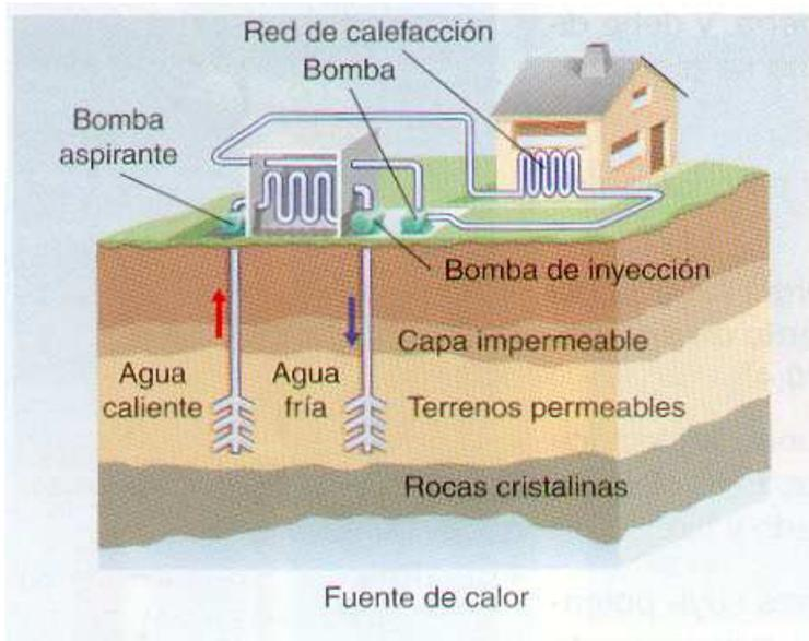
La temperatura del foco oscila en torno a los 100°C. Se utilizan para calefacción, invernaderos, balnearios, etc.
