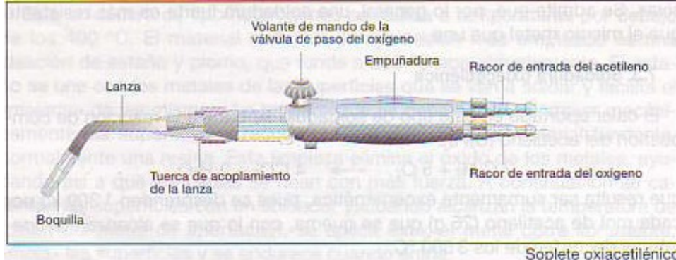
Figura 11.30. Elementos de que consta un equipo de soldadura oxiacetilénica
