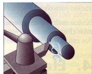
Figura 4.8(i). Maquinabilidad. Facilidad que tiene un cuerpo a dejarse cortar por arranque de viruta.
