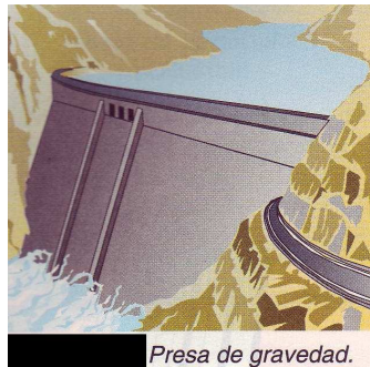
Presa de gravedad.
