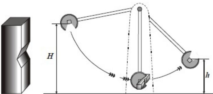
El más característico es el ensayo Charpy. En este ensayo se utiliza una probeta de sección cuadrada provista de una entalladura que es sometida a la acción de una carga de ruptura por medio de un martillo que se desplaza en una trayectoria circular.
