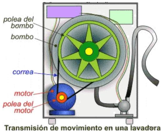
Ejemplo de aplicación de un reductor.
